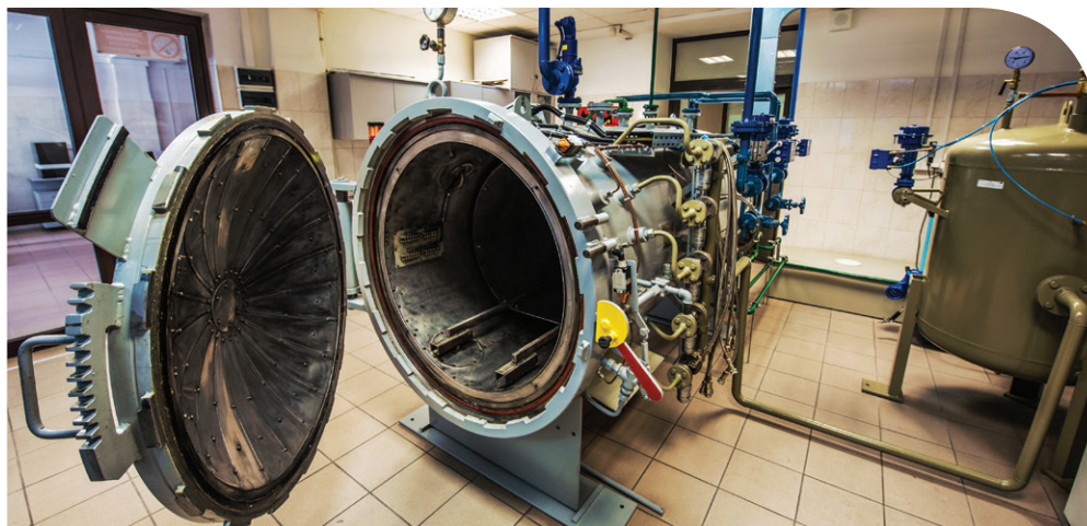
AUTOKLAW - SPECJALISTYCZNY PIEC WYKORZYSTYWANY DO WYTWARZANIA MATERIAŁÓW KOMPOZYTOWYCH
