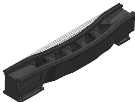
Rys. 6.14 Postać F1 korpusu hybrydowego (częstotliwość 195 Hz)
