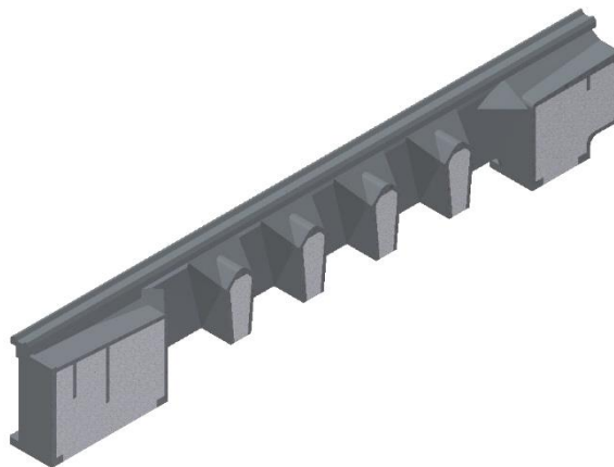
Rys. 6.4 Przekrój korpusu z przestrzeniami wypełnionymi odlewem mineralnym
