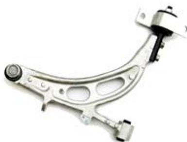
Rys. 2.19 Przykładowe modele wahaczy stosowane w quadach: a) wahacz dolny z regulacją stosowany w quadach [6], b) wahacz dolny bez regulacji stosowany w Subaru Impreza WRX [24]
