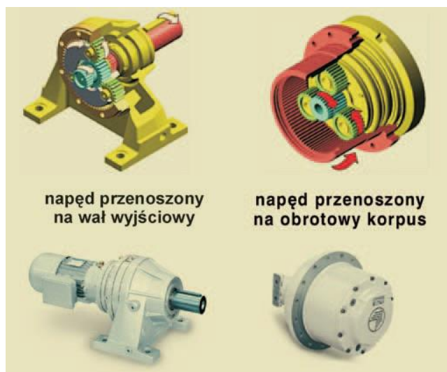
Rys. 1.5 Schemat przeniesienia napędu w podstawowej przekładni planetarnej [14]
