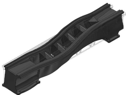
Rys. 6.15 Postać F4 korpusu żeliwnego (częstotliwość 393 Hz)
