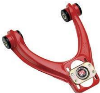
Rys. 2.19 Przykładowe modele wahaczy stosowane w quadach: a) wahacz dolny z regulacją stosowany w quadach [6], b) wahacz dolny bez regulacji stosowany w Subaru Impreza WRX [24]
