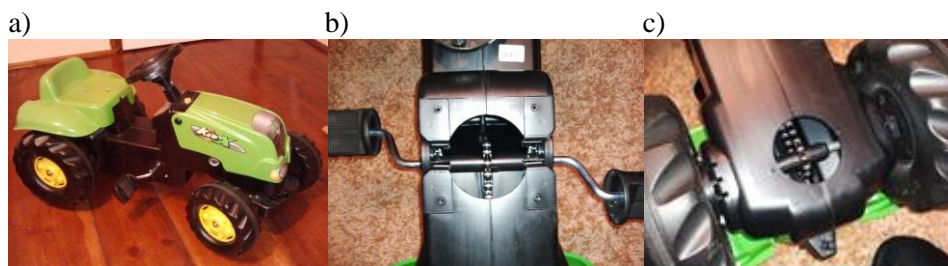
Rys. 2.2 Pojazd o napędzie łańcuchowym: a) przedstawienie imitacji traktorka, b) połączenie korb z pedałami wraz z łańcuchem napędzającym, c) ukazanie napędu w postaci łańcucha
