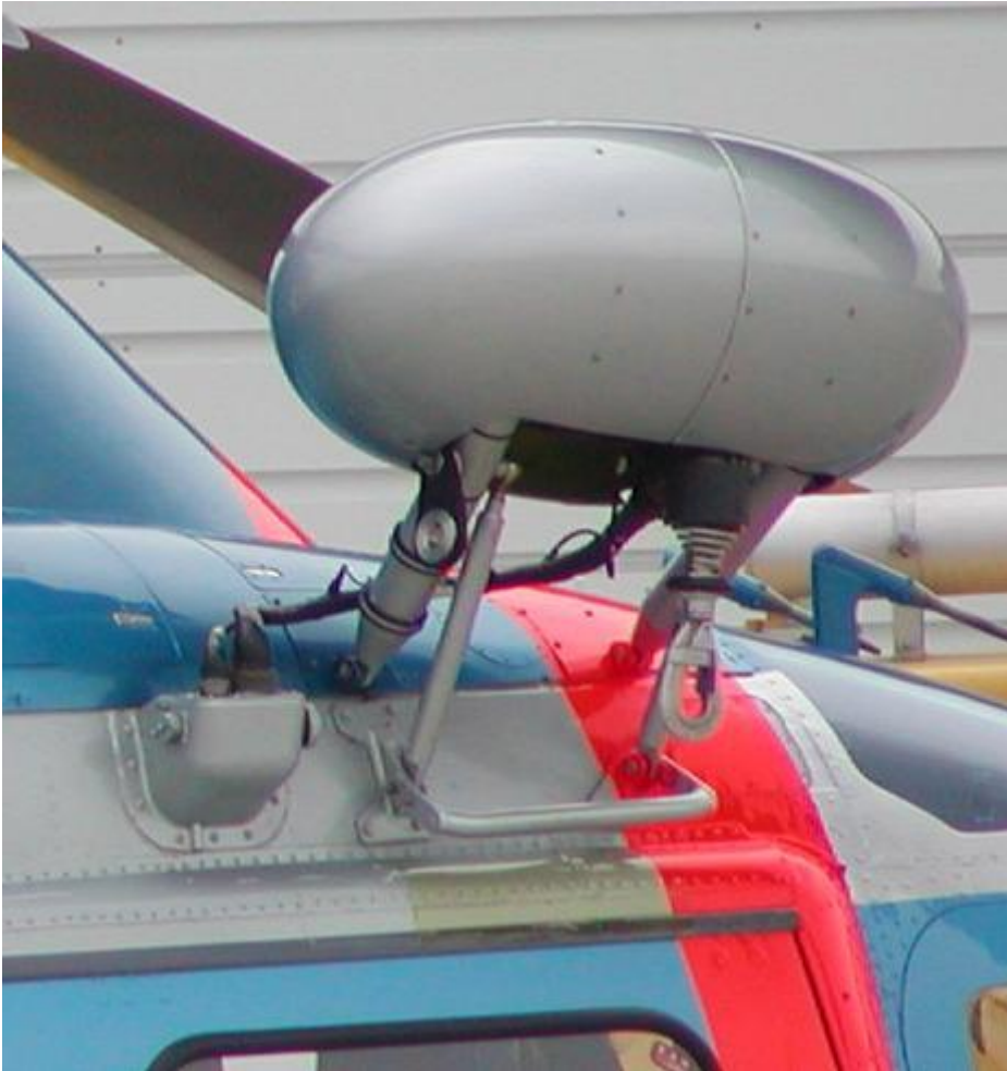
Rys. 7.9 Sposób zamocowania wciągarki na śmigłowcu AW 109 [6]
