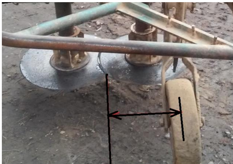
Rys. 3.12. Dwutarczowa ogławiarka z wprowadzonymi zmianami konstrukcyjnymi – odsunięcie koła kopiującego od linii cięcia tarcz
