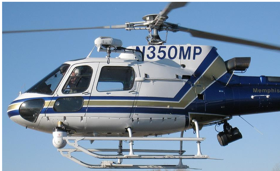
Rys. 7.11 Rozłożenie Kamery termowizyjnej, Szperacza oraz wciągarki na śmigłowcu AS 350[20]
