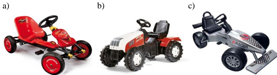
Rys. 2.3 Pojazdy z napędem łańcuchowym: a) pojazd przypominający typowy gokart [8], b) pojazd o nadwoziu imitującym traktor [23], c) pojazd imitujący model formuły F1 [9]
