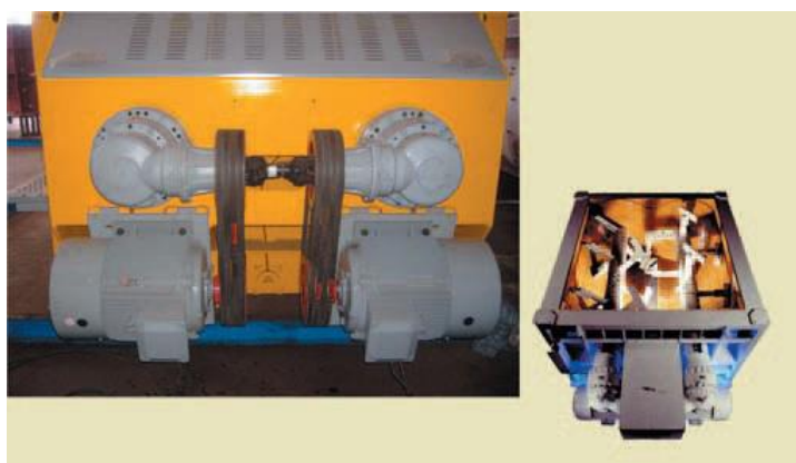
Rys. 1.10 Napęd mieszalnika z synchronizacją mechaniczną [14]
