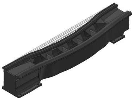
Rys. 6.13 Postać F1 korpusu żeliwnego (częstotliwość 189 Hz)
