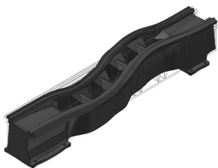
Rys. 6.16 Postać F4 korpusu hybrydowego (częstotliwość 425 Hz)
