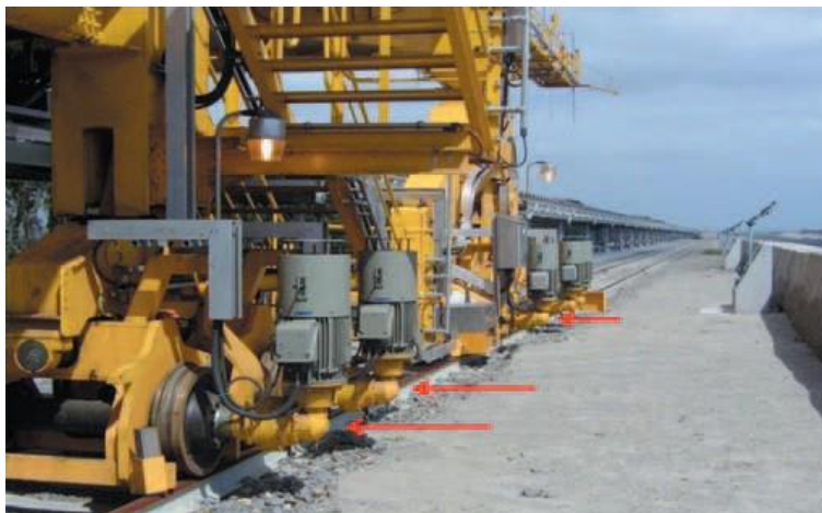
Rys. 1.9 Napęd jazdy – przekładnie planetarne mocowane bezpośrednio na osiach napędzanych kół jezdnych [14]
