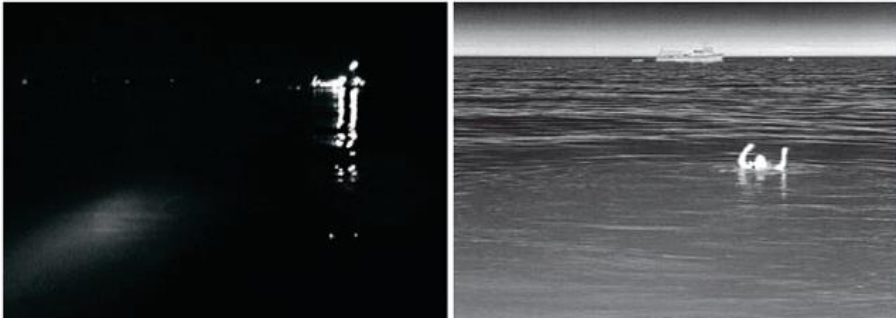
Rys. 7.3 Różnice w postrzeganiu obrazu bez kamery termowizyjnej i z kamerą [8]
