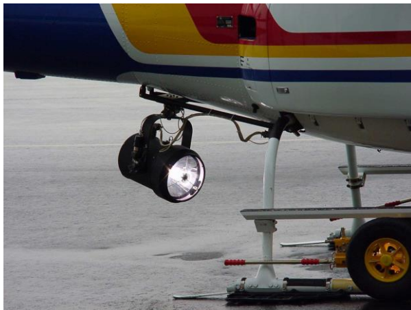
Rys. 7.4 Szperacz na śmigłowcu Eurocopter AS 350 [10]
