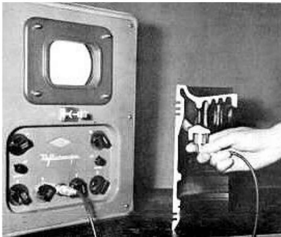
Rys. 1.1. Supersonic Reflectoscope służący do lokalizowania wad w materiałach [30]
