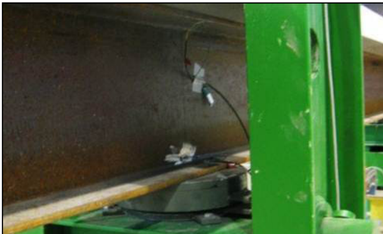
Fot. 9. Sposób podparcia elementów badawczych [autor K. Śledziwski]
