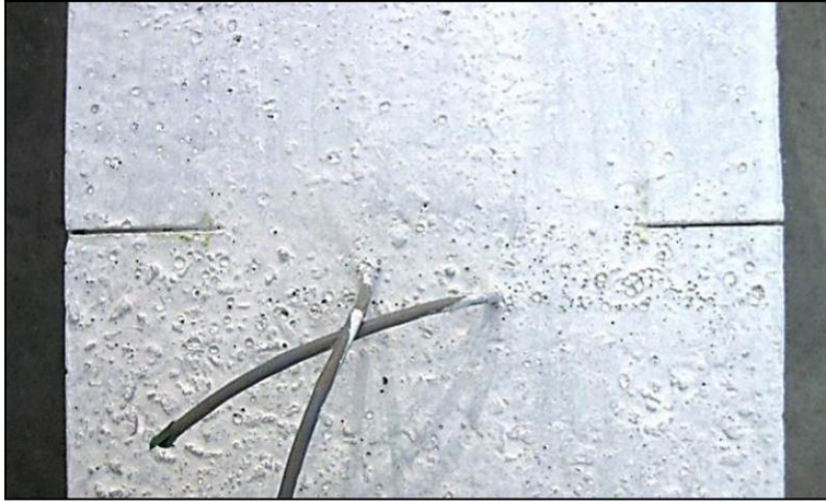
Fot. 6. Wymuszone kształtowanie rysy [autor K. Śledziewski]
