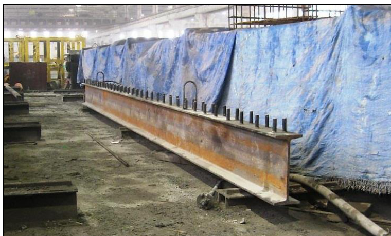
Fot. 2. Widok belki z łącznikami [autor K. Śledziewski]
