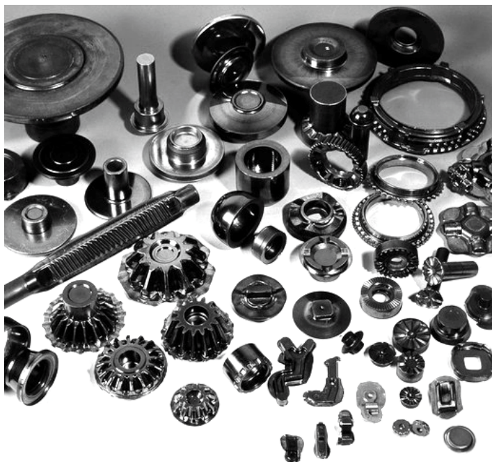
Rys. 1.2. Asortyment odkuwek kształtowanych na zimno za pomocą technologii prasowania obwiedniowego [65, 70]
