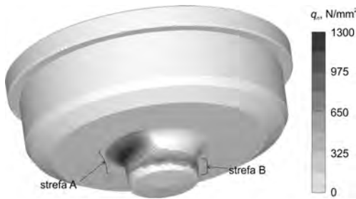
Rys. 5.40. Rozkład nacisków jednostkowych na powierzchni stempla w momencie największego obciążenia – przypadek nawiązujący do rys. 5.39, gdy F_{max} = 470 kN
