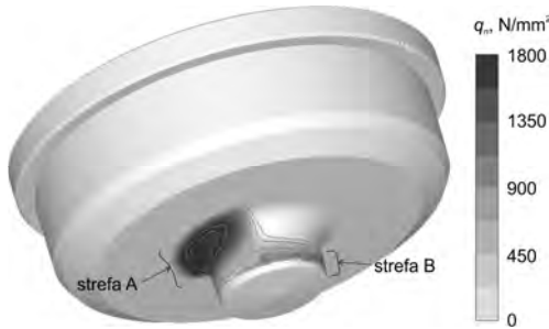
Rys. 5.40. Rozkład nacisków jednostkowych na powierzchni stempla w momencie największego obciążenia – przypadek nawiązujący do rys. 5.39, gdy F_{max} = 470 kN
