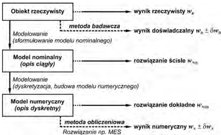
Rys. 2.2. Etapy budowy modelu numerycznego oraz wyniki i rozwiązania uzyskiwane na poszczególnych poziomach modelowania
