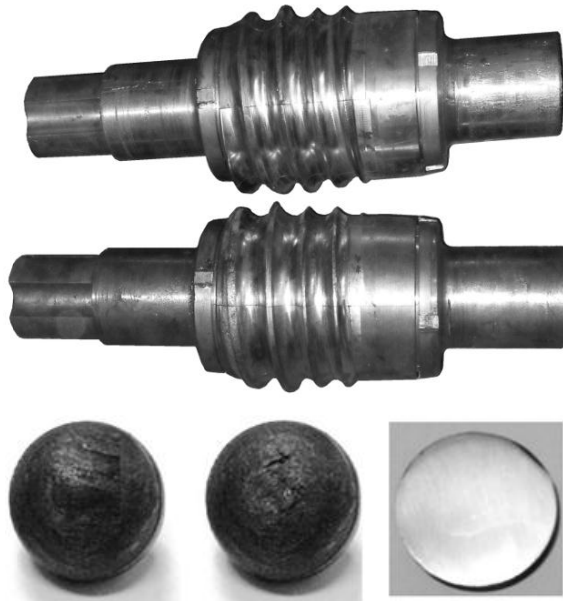
Rys. 1.55. Walce wykorzystywane w procesie walcowania śrubowo-klinowego (u góry) oraz kule o średnicy \varnothing 33 mm uzyskane przy ich użyciu (u dołu) [78]
