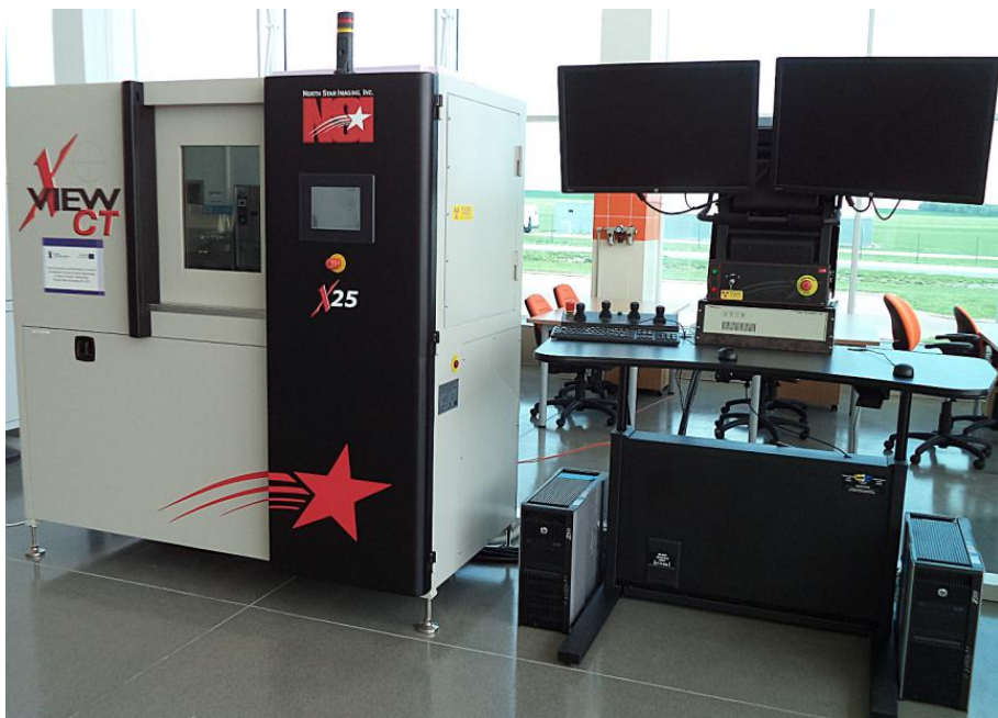
Rys. 7.17. Rentgen X-VIEW model X25 firmy NSI North Star Imaging Inc., wykorzystany do badań defektoskopowych
