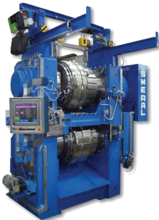
Rys. 1.19. Walcarka poprzeczno-klinowa firmy Šmeral typu ULS 100 RA [185]
