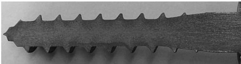
Rys. 1.52. Przekrój wzdłużny przez część gwintowaną wkręta szynowego otrzymanego z wykorzystaniem procesu walcowania poprzeczno-klinowego [113]
