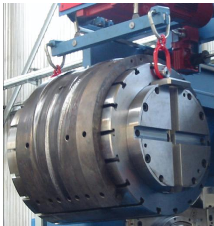
Rys. 1.24. Sposób mocowania narzędzi w walcierce poprzeczno-klinowej QKW 700 [140]
