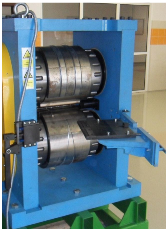
Rys. 5.9. Narzędzia klinowe wykorzystane do walcowania odkuwki zamontowane na wałach głównych walcarki
