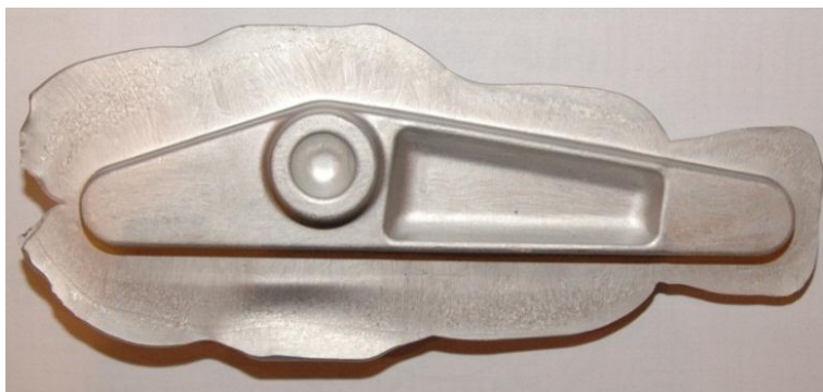
Rys. 7.19. Odkuwka dźwigni ukształtowana z przedkuwki walcowanej w procesie WPK (z pozostawioną wyplawką)
