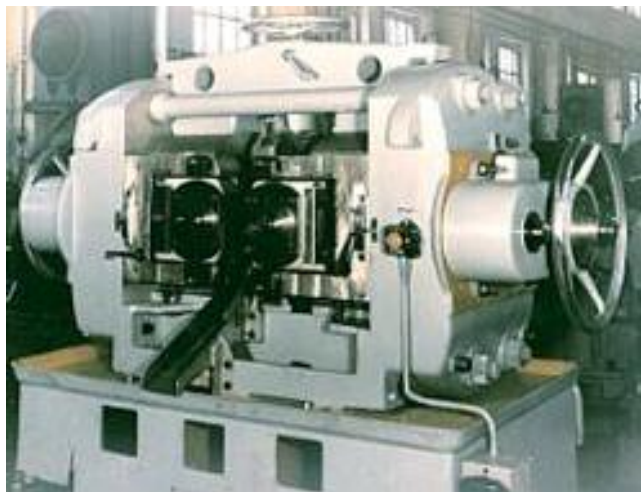
Rys. 1.33. Klatka robocza walcarki skośnej ШПС 20-60 firmy VNIIMETMASH [186]
