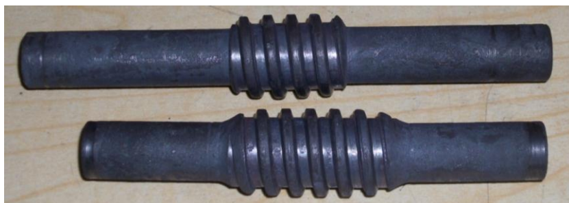
Rys. 1.50. Wałki ze ślimakami (uzwojenie jednokrotne, wysokość zwoju 3 mm) otrzymane metodą walcowania poprzecznego [81]
