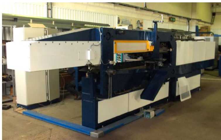
Rys. 1.28. Walcarka płaskoklinowa WRL 4012, produkowana przez zakłady AMT Inżyniring [180]
