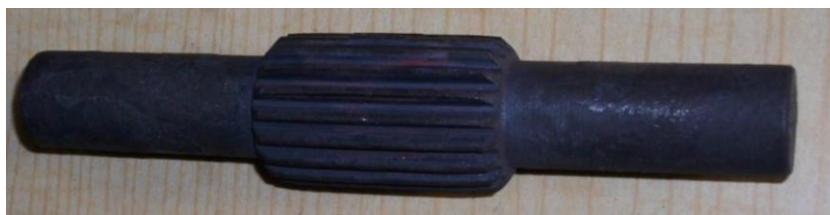
Rys.1.49. Wałek z uzębieniem prostym (liczba zębów 18, moduł 1,5) otrzymany metodą walcowania poprzecznego [81]
