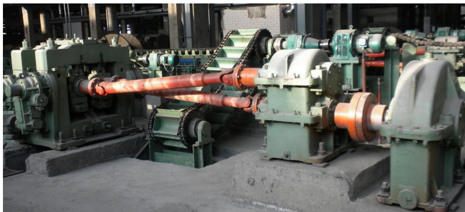
Rys. 1.34. Linia walcownicza do walcowania skośnego kul o wymiarach \varnothing 60 mm firmy Anyang Forging Press Machinery Industry (Chiny) [183]
