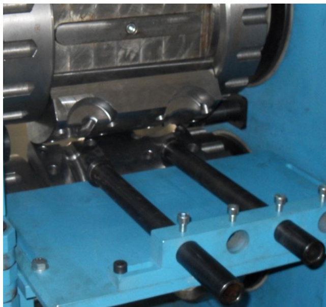
Rys. 4.10. Segmenty narzędziowe do walcowania kuźniczego odkuwek stopniowanych wałków, zamontowane w przestrzeni roboczej klatki walcowniczej
