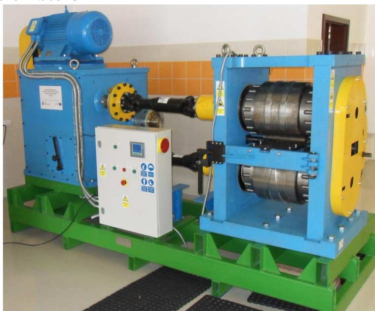
Rys. 3.2. Prototypowa walcarka kuźnicza do walcowania wzdłużnego, poprzecznego i dzielenia bezodpadowego
