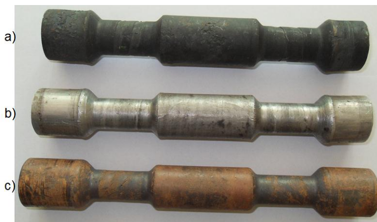
Rys. 5.13. Odkuwki stopniowanego wałka odwalcowane metodą WPK podczas prób w uniwersalnej walcarce kuźniczej: a) ze stali C45, b) ze stopu aluminium 2618, c) ze stopu tytanu Ti6Al4V
