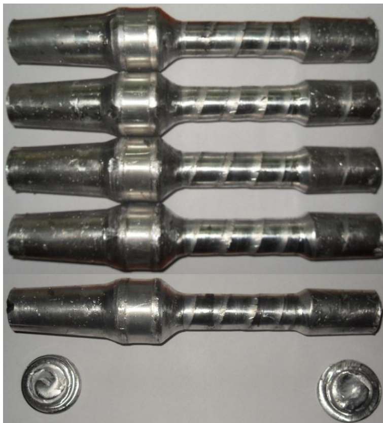
Rys. 7.15. Przedkuwki dźwigni ze stopu aluminium 2014A ukształtowane w procesie WPK w uniwersalnej walcarni kuźniczej
