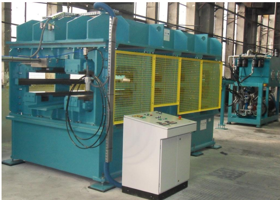
Rys. 1.31. Nawrotna walcarka płaskoklinowa opracowana w Politechnice Lubelskiej
