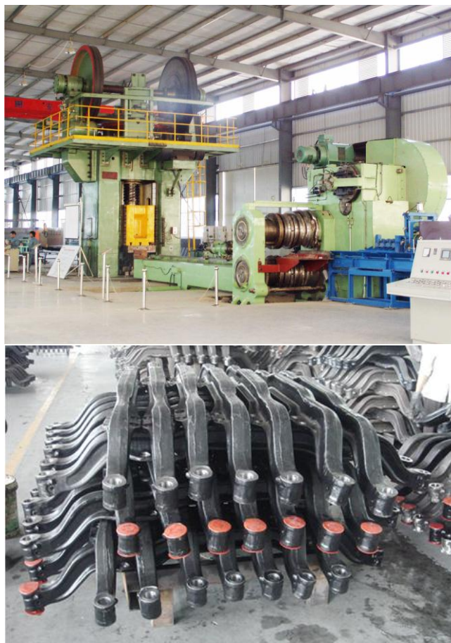
Rys. 1.43. Widok linii do wytwarzania belek osi przedniej samochodu wraz z wyprodukowanymi w niej przykładowymi wyrobami [117]
