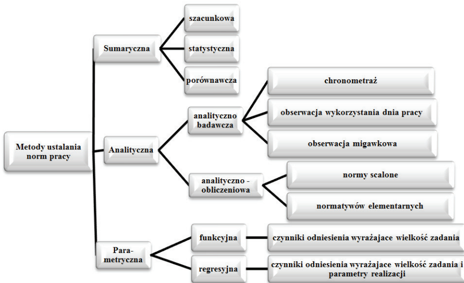
Rys. 2.2. Metody ustalania norm pracy z uwzględnieniem metody parametrycznej
