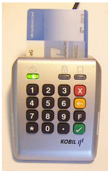
Rysunek 5. Karta kryptograficzna wraz z czytnikiem
