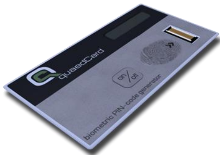
Rysunek 7. Token OTP zabezpieczony czytnikiem linii papilarnych
