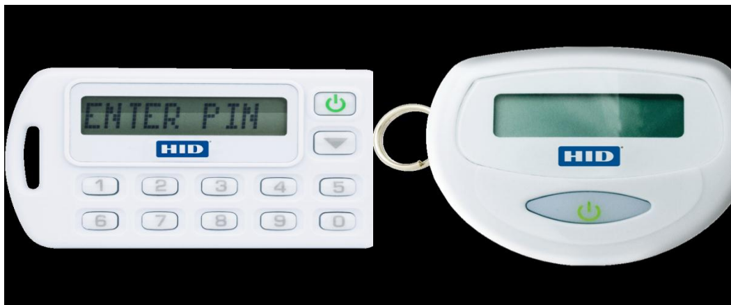
Rysunek 1. Przykładowe tokeny OTP typu „kalkulaterek” i „brelok”
