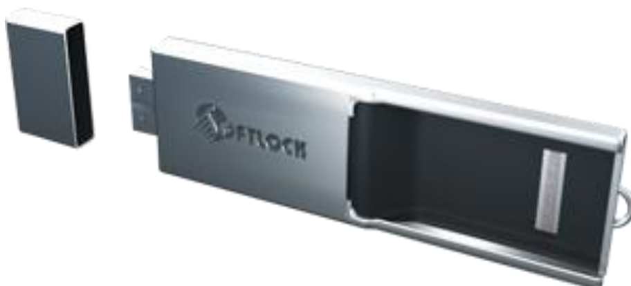
Rysunek 8. Token USB zabezpieczony czytnikiem linii papilarnych
