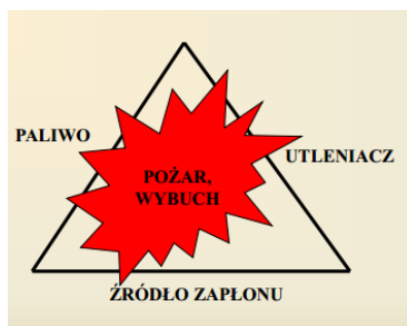
Rys. 1 Warunki niezbędne do powstania pożaru, tzw. trójkąt pożarowy [13]
