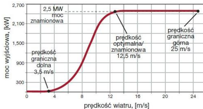
Rys.7. Charakterystyka mocy turbiny GE Energy o mocy 2,5 MW, (Control Engineering Polska)
