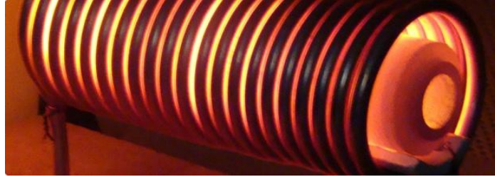
Rys 4. Poprawnie nawinięty wzbudnik z rury miedzianej \phi 6mm
