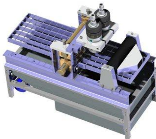
Rys. 5. Wygląd urządzenia do rozdrabniania opon metodą Water-Jet (a) oraz opony poddanej rozdrabnianiu tą metodą (b) [25]
