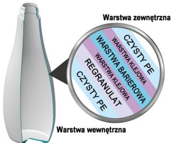
Rys. 4. Układ warstw w typowym pojemniku wielowarstwowym otrzymanym metodą rozdmuchiwania w formie [13]
