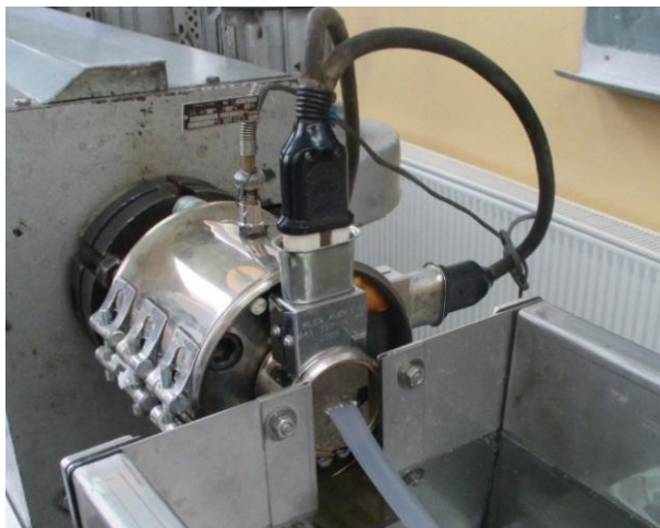
Rys. 5. Wygląd głowicy wytłaczarskiej z wytłaczaną taśmą z PVC i proszku żelaza
