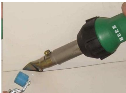
Rys. 4. Zgrzewanie folii nagrzanym klinem; zasada: 1 – nagrzaný klin, 2 – folia zgrzewana, 3 – rolka dociskająca, przykład zgrzewarki ręcznej Herz Rion [4, 14]
