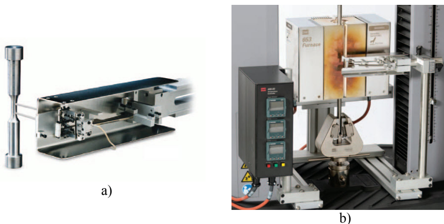
Rys. 9.21 Wykorzystanie ekstensometru wysokotemperaturowego [75]
