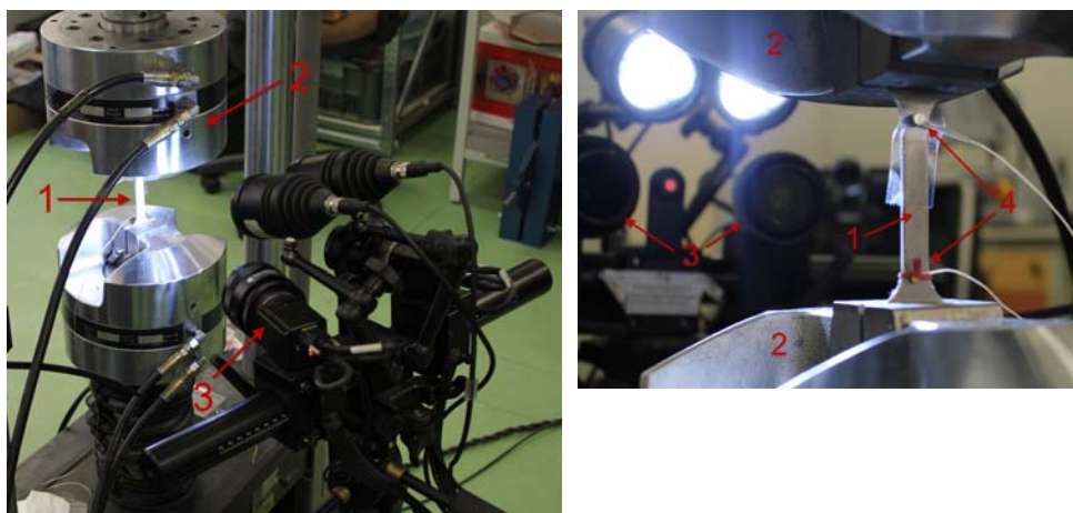
Rys. 9.22. Użycie systemu Aramis oraz emisji akustycznej (źródło: badania własne)
