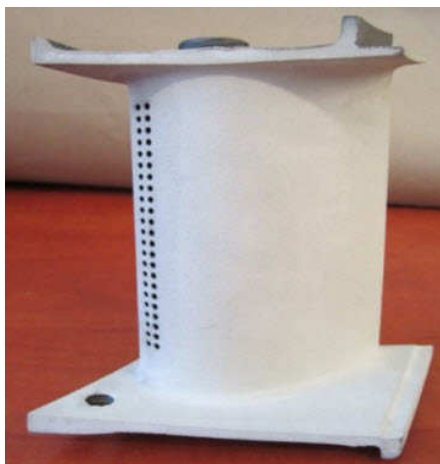
Rys. 3.13. Kształtowanie otworów na powierzchni łopatkę kierującej [55]
