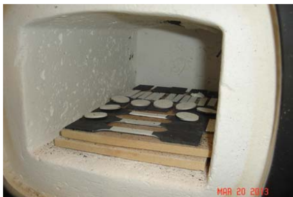
Rys. 9.34. Rozmieszczenie próbek w piecu muflowym
