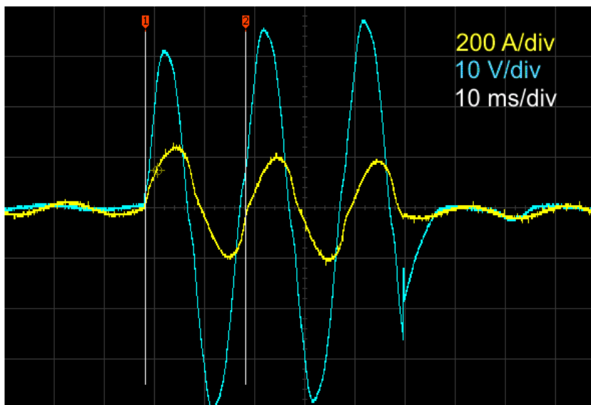
Rys. 7.2 Oscylogram uzyskany dla konfiguracji zwojowej 1A przy U_s = 40 V
