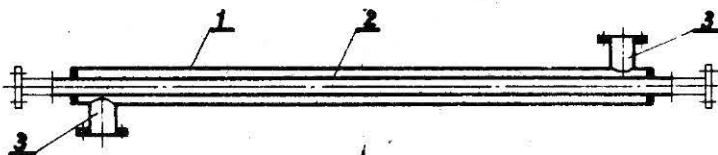
Rys. 11. Wymiennik ciepła "rura w rurze" bez kompensacji, jednoczłonowy (221-0.01.0): 1 - rura zewnętrzna, 2 - rura wewnętrzna, 3 - króciec
