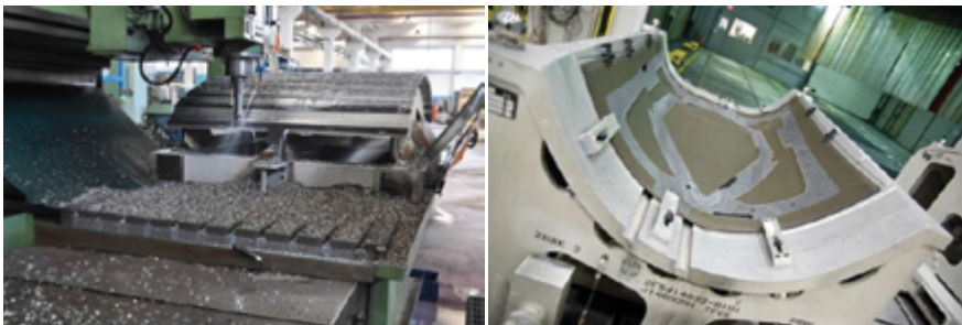
Rys. 12.12. Przykłady oprzyrządowania specjalnego do obróbki struktur cienkościennych [14]
