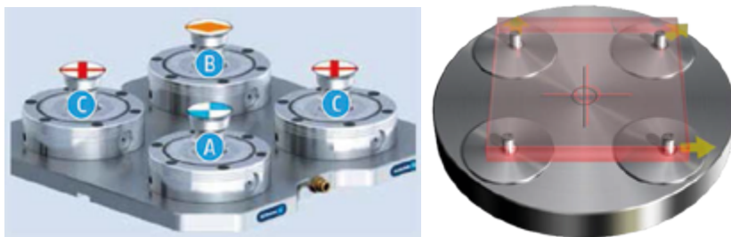
Rys. 12.45. System wielomodułowy w układzie tradycyjnym oraz możliwy błąd wywołany takim rozwiązaniem [21,32]
