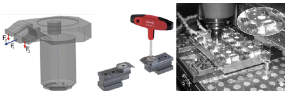
Rys. 12.32. Docisk boczny sprężysty [15]
