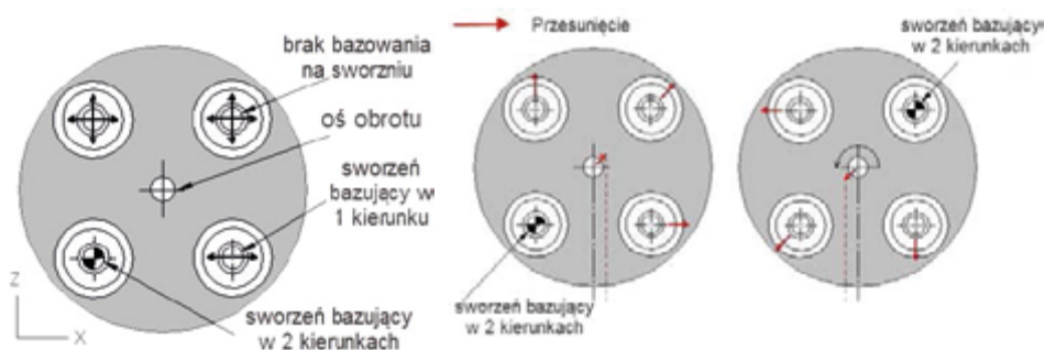
Rys. 12.46. Schemat rozmieszczenia sworzni bazujących w systemie wielomodułowym oraz przyczyna powstawania błędu podczas rotacji stołu [32]
