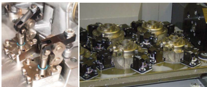
Rys. 12.38. Przykłady zamocowania przedmiotów za pomocą układów hydraulicznych [18]
