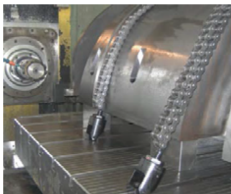
Rys. 12.40. Zestaw do mocowania łańcuchowego oraz przykład zamocowania [18]
