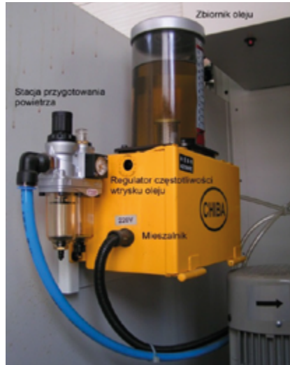
Rys. 9.6. Układ MQL stosowany na frezarkach pionowych [17]
