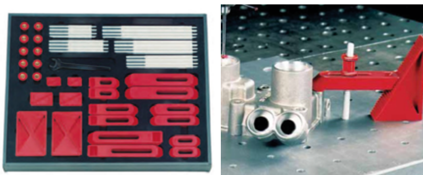
Rys. 12.37. Zestaw elementów mocujących z PBT oraz przykład zamocowania na elemencie cienkościennym [15]
