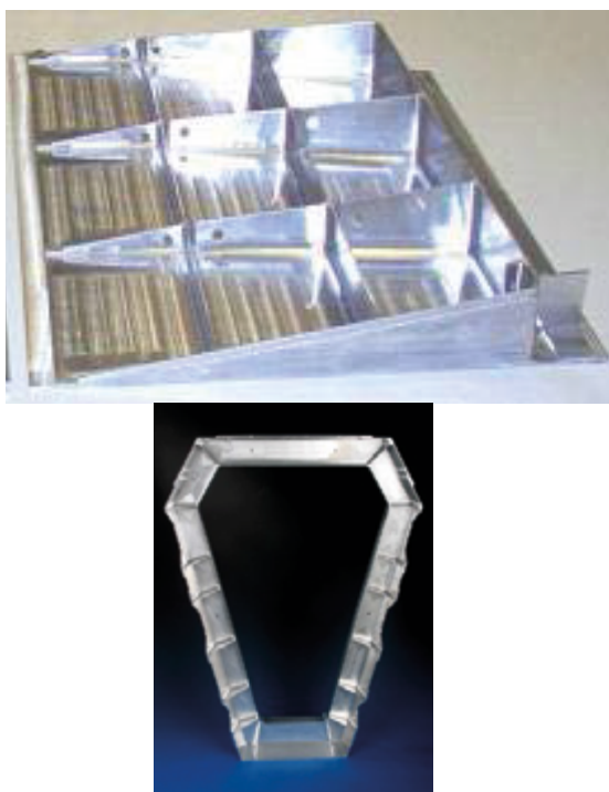
Rys. 11.1. Przykłady konstrukcji kieszeniowych zastosowanych w elementach strukturalnych statków powietrznych [6, 9]
