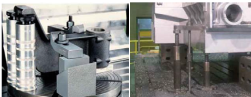
Rys. 12.28. Przykłady konstrukcji podpórek śrubowych stosowanych przy obróbce ubytkowej [15]
