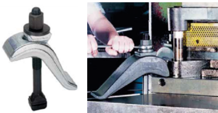
Rys. 12.26. Łapa dociskowa nastawna z bezstopniową regulacją wysokości [15]
