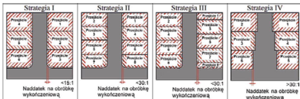
Rys. 10.8. Strategie obróbki cienkich ścianek [12, 14]
