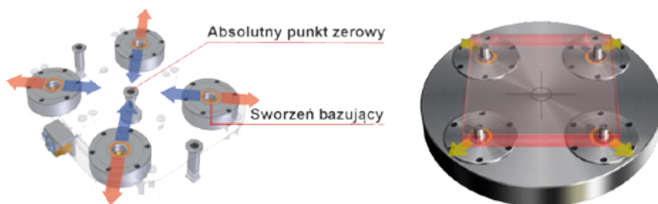
Rys. 12.47. Opcjonalne rozmieszczenie pozwalające kompensować wpływ temperatury [32]
