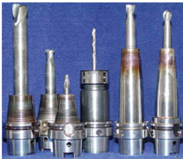
Rys. 11.2. Przykłady narzędzi o różnych wysięgach [1]
