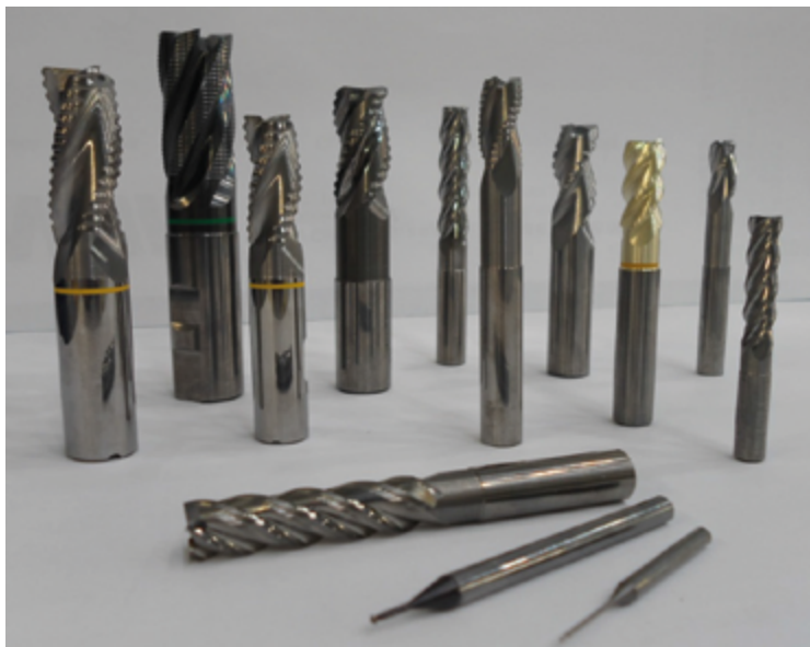
Rys. 6.1. Zestaw frezów pełnowęglkowych do obróbki HPC i HSC
