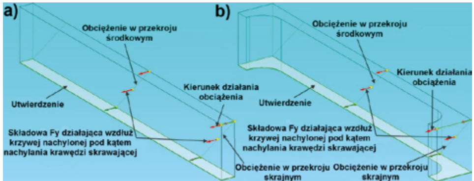
Rys. 10.16. Modele obciążenia oraz utwierdzenia przyjęte w analizie MES: a) ścianek nieutwierdzonych, b) ścianek utwierdzonych
