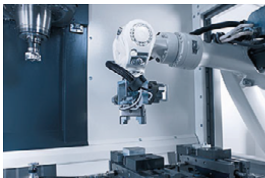
Rys. 12.2. Zrobotyzowana wymiana przedmiotu obrabianego w przestrzeni obróbkowej i poza nią [27]
