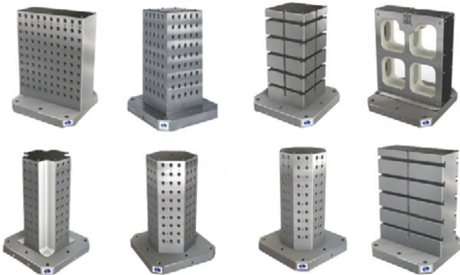
Rys. 12.42. Przykłady rozwiązań konstrukcyjnych paletowych skrzyń kolumnowych [19]
