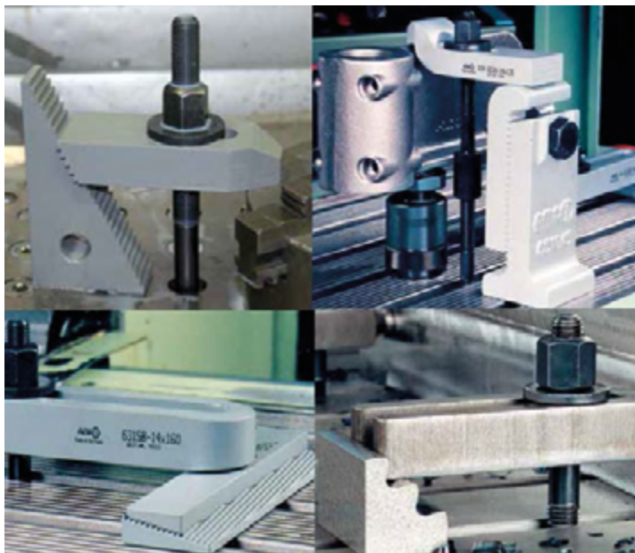
Rys. 12.27. Przykłady wykorzystania różnych podpórek przy mocowaniu łapami [15]
