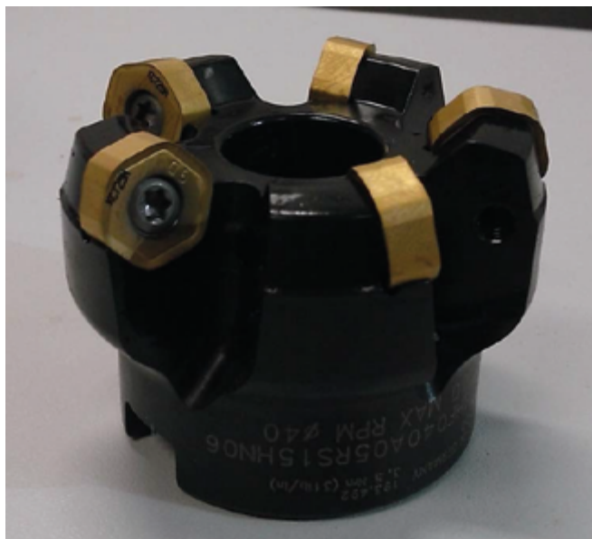
Rys. 6.7. Głowica do obróbki z dużymi posuwami
