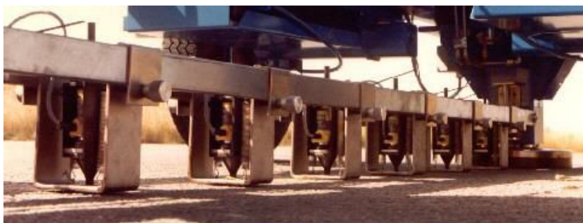
Fot. 1.2. Czujniki przemieszczeń pionowych – rozmieszczenie geofonów na belce [http://www.road.pl/fwd.htm] [Data dostępu: 16.07.2004 r.]
