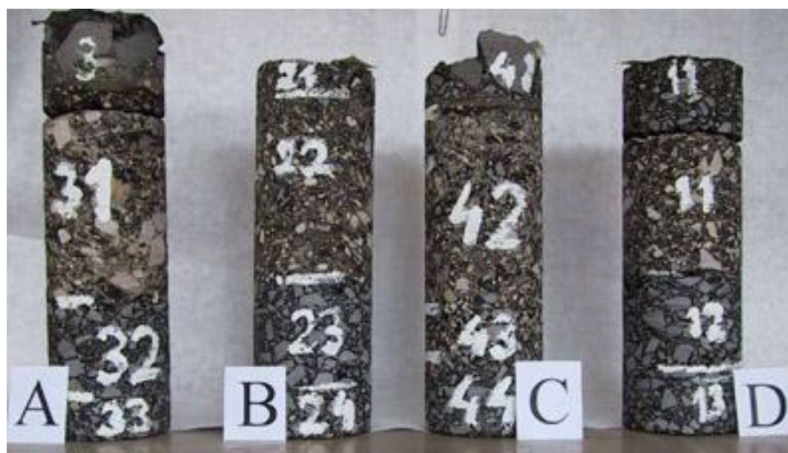
Fot. 6.6.3. Odwierty próbek z nawierzchni
