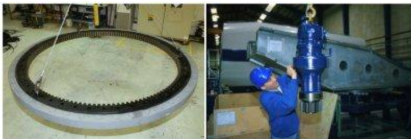
Rys. II.44. Elementy składowe mechanizmu regulacji kierunku [II.16]
