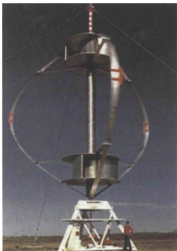
Rys. II.29. Turbina wiatrowa Darrieus'a z wirnikami rozruchowymi Savoniusa [II.1]
