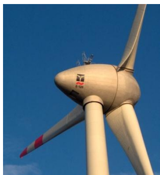
Rys. II.24. Turbina wiatrowa firmy ENERCON o mocy 7,5 MW [II.10]
