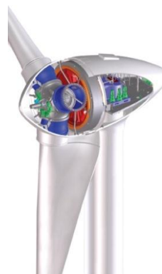
Rys. II.47. Gondola elektrowni wiatrowej ENERCON E-70o mocy 2 300 kW z wolnoobrotowym generatorem energii elektrycznej, bez przekładni [II.12]
