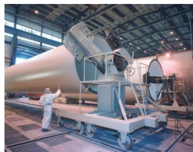
Rys. II.62. Etapy produkcji segmentów wieży stalowej elektrowni wiatrowej [II.9]
