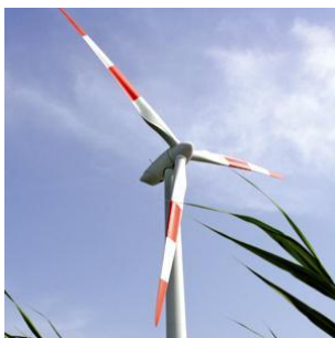
Rys. II.26e. Turbina wiatrowa PowerWind 56 dużej mocy - 900 kW, firmy PowerWind [II.10]
