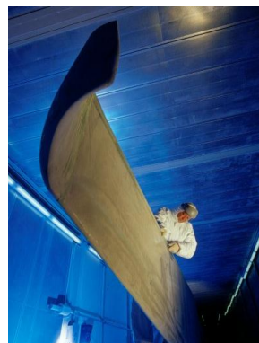
Rys. II.53. Wygięcie końcówki płata w celu ograniczenia strat aerodynamicznych i ograniczenia emisji hałasu [II.9]
