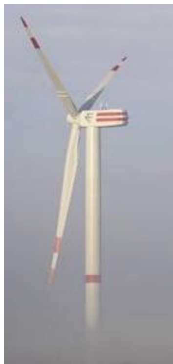
Rys. II.23. Turbina wiatrowa firmy Re Power Systems o mocy 6,15 MW i jej parametry [II.10]
