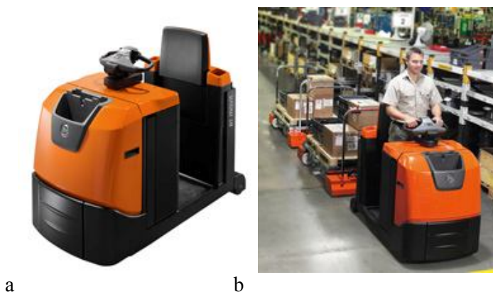
Rys. 2.19. Ciężki wózek holowniczy BT Movit serii S [45]: a – widok ogólny wózka, b – przykład zastosowania
