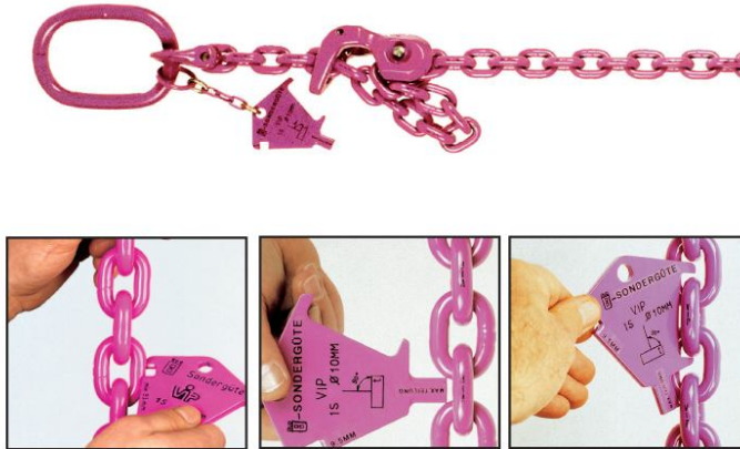
Rys. 4.17. Zastosowanie błyszki cechowej do sprawdzania zużycia [41]: a – sprawdzenie średnicy, b – kontrola rozciągnięcia, c – kontrola długości ogniwa
