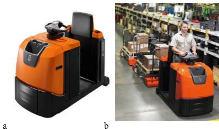
Rys. 2.19. Ciężki wózek holowniczy BT Movit serii S [45]: a – widok ogólny wózka, b – przykład zastosowania
