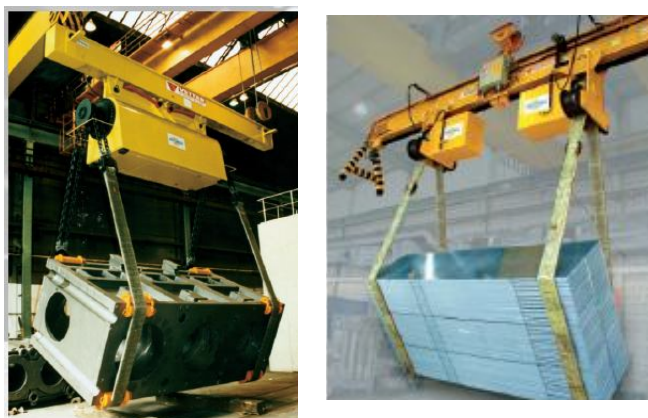
Rys. 4.23. Trawery specjalistyczne [31]: a – typ THRR, b – typ TT, c – typ TCZ, d – trawers TPB do podnoszenia pakietów blach, e – trawers TPS do podnoszenia skrzyń, f – trawers TPK do podnoszenia kontenerów
