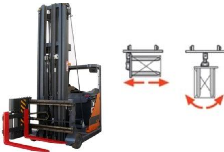
Rys. 2.13. Wózek do wysokiego komisjonowania OMG NEOS II TRI AC z przesuwną i obracaną karetką [39]
