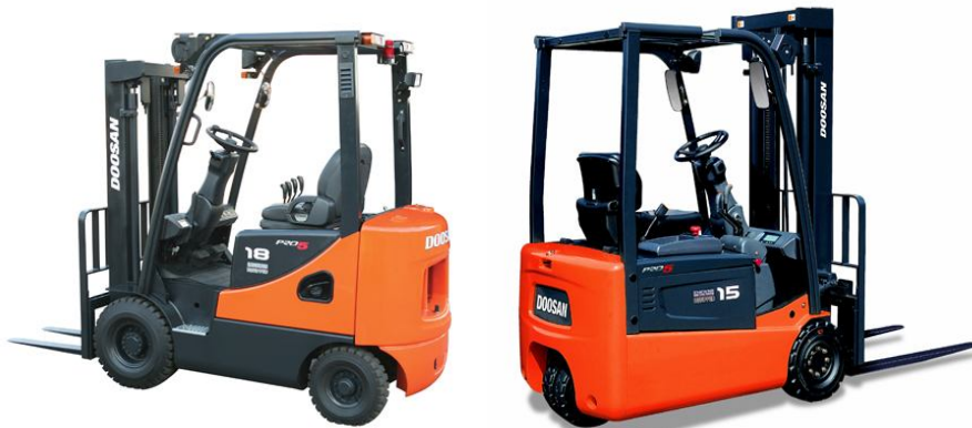
Rys. 2.6. Wózek podnośnikowy widłowy z napędem a- spalinowym, b- elektrycznym [4]
