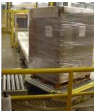
Rys. 1.6. Obrotnice wałkowe [14]: a – zmiana kierunku transportu ładunku spaletyzowanego, b – widok urządzenia
