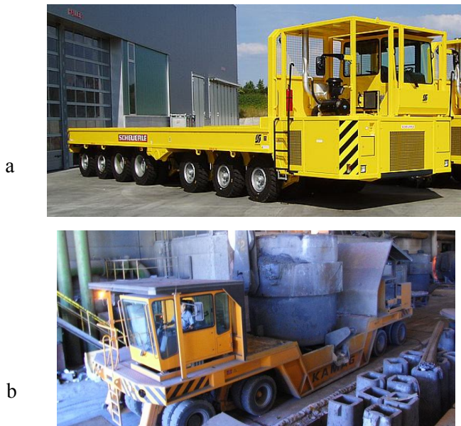
Rys. 2.37. Wózki przewoźące o dużej ładowności stosowane w hutnictwie: a – wózek firmy Scheuerle [42], b – wózek firmy Kamag [8]
