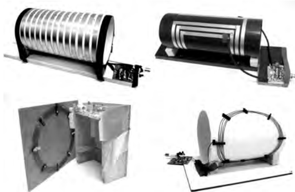
Rys. 1. Wykonane cewki w.cz. - od lewej do prawej w pierwszym rzędzie: cewki objętościowe: solenoidalna i siodłowa; poniżej cewki powierzchniowe: płaska i zaokrąglona
