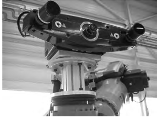
Rys. 2. Adapter mocujący skaner optyczny na ramieniu robota
