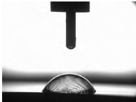
Rys. 2. Po lewej - pomiar kąta zwilżania z geometrii kropli, po prawej – widok naniesionej kropli cieczy pomiarowej
