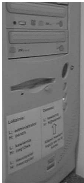
Fot. 4.1. Loginy i hasła dostępne na kartce przyklejonej do komputera (źródło: opracowanie własne)
