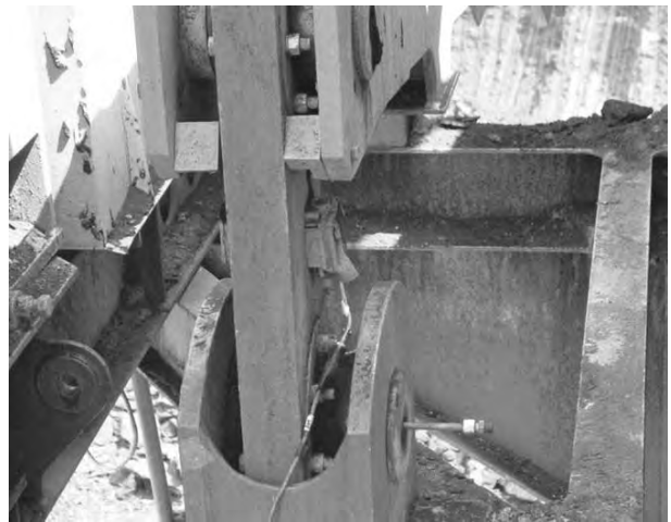
Rys. 5. Lokalizacja czujnika tensometrycznego na łączniku dźwigni momentowej
