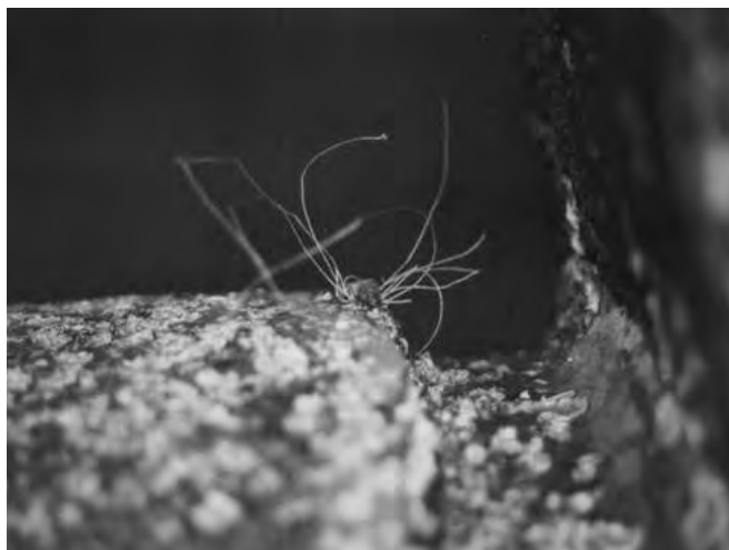
Rys.10. Żyłka (pozostałość sieci rybackiej) wkręcona w uszczelnienie pochwy wału śrubowego kutra rybackiego Fig 10. Filaments (remains of a fish net) fouled in the stern tube sealing of a fishing vessel
