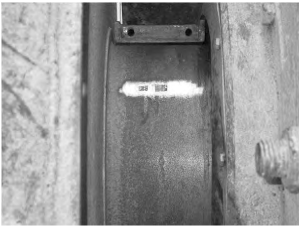
Rys. 3. Przygotowanie układu pomiarowego i widok układu tensometrycznego do pomiaru momentu skręcającego na wale koła czerpakowego
