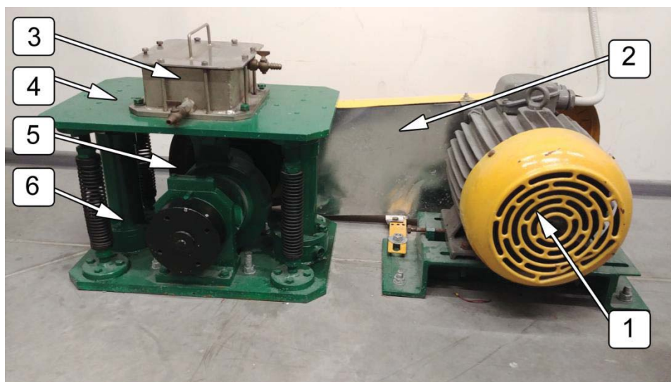
Rys. 4.10. Stanowisko do nagniatania wibracyjnego: 1 – silnik elektryczny, 2 – przekładnia pasowa, 3 – komora robocza, 4 – stół, 5 – mechanizm korbowy, 6 – prowadnica pionowa
