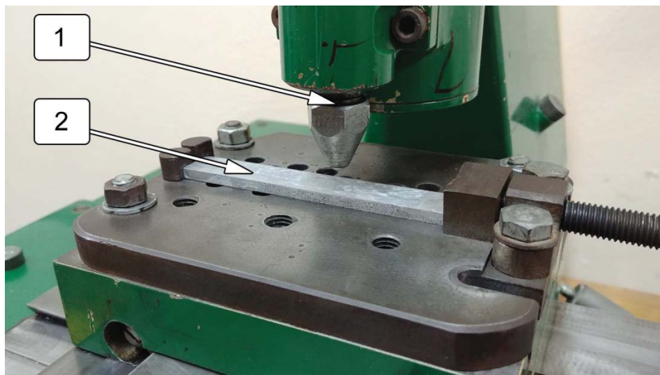
Rys. 3.5. Część robocza urządzenia do nagniatania impulsowego płaszczyzn: 1 – suwak z elementem nagniatającym, 2 – przedmiot obrabiany
