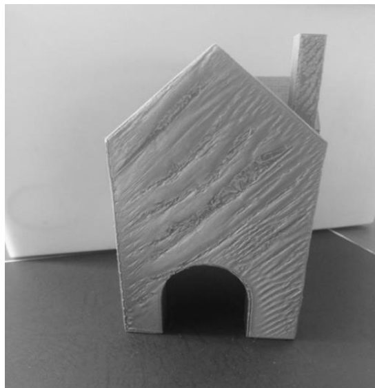
Rys. 2. Widok elementu z postrzępioną pierwszą warstwą
