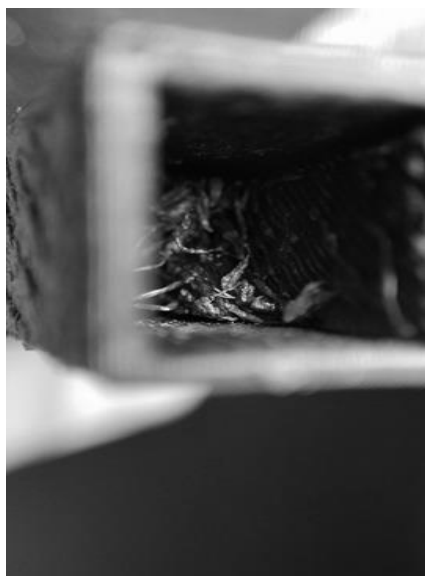
Rys. 3. Widok elementu posiadającego podpory, których nie da się usunąć bez uszkodzenia modelu
