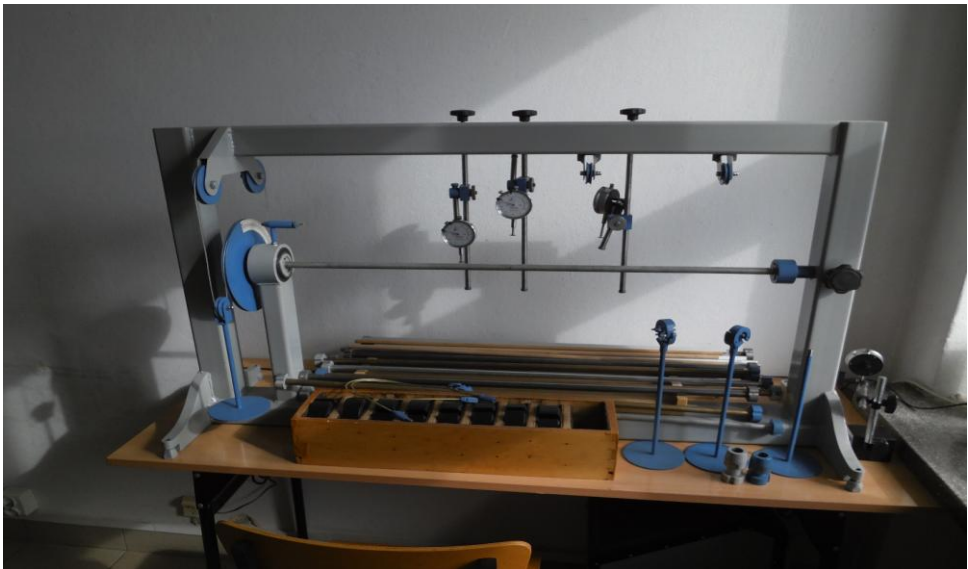
21. Stanowisko badawcze (zginanie i skręcanie prętów) – zaprojektowane i wykonane przez studentów kierunku ETI w ramach realizacji prac magisterskich (czerwiec 2014, autorzy pracy: Domżał Krzysztof i Gustyn Piotr, promotor: dr inż. Wiesław Wójcik)
