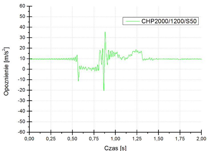
Rys. 7.56. Charakterystyka hamowania chwytacza typu CHP2000 w warunkach z mieszaniną smaru z piaskiem kwarcowym z obciążeniem 1200 kg
