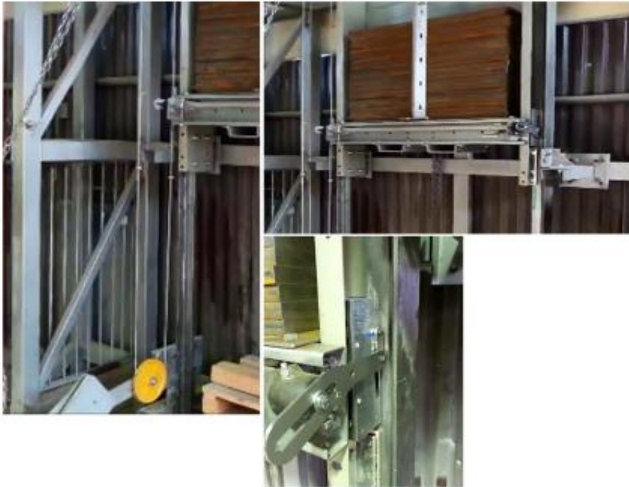
Rys. 4.8. Stanowisko do wykonywania testów metodą spadku swobodnego (opracowanie własne)
