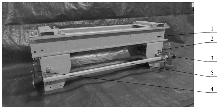
Rys. 4.1. Przykładowa zabudowa chwytacza w ramie badanego układu: 1 – belki nośne ramy, 2 – korpus chwytacza, 3 – układ nadzorujący położenie rolki w chwytaczu, 4 – chwytacz, 5 – łącznik kinematyczny chwytacza
