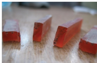
Fot. 6.11 Próbki po badaniu na zginanie. Od lewej z wypełnieniem w postaci rowingu szklanego oraz po prawej - drutu stalowego
