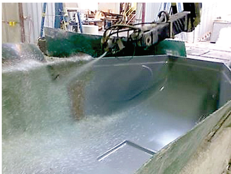
Fot. 6.3. Laminowanie natryskowe przy pomocy robotów ( www.baltazarkompozyty.pl )
