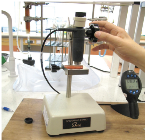
Fot. 6.13. Próbką podczas badania twardości na twardościomierzu Shore'a typ D.
