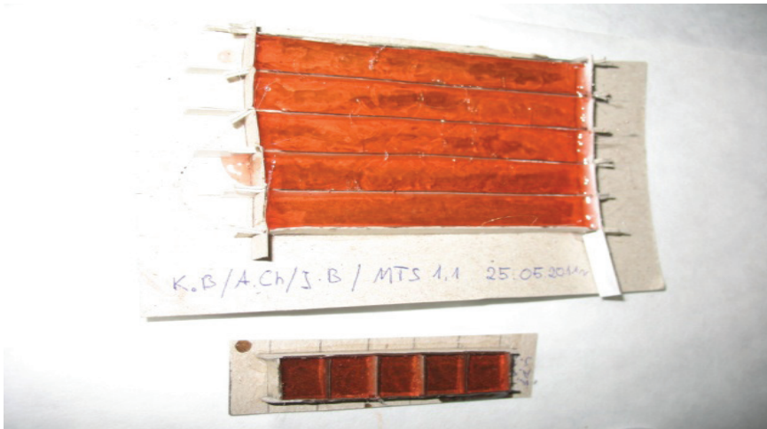
Fot. 6.9. Przykładowa forma z kartonu dla 5 próbek kompozytu polimerowego z uwzględnieniem geometrii próbek do badań wytrzymałości na zginanie
