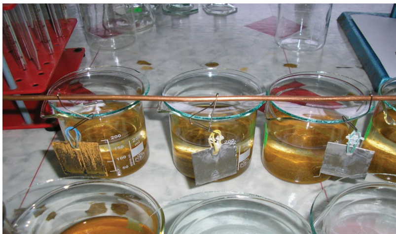
Fot. 1.7. Próbkę stali St3S, po 28-dniowej ekspozycji w rozcieńczonym kwasie siarkowym. Po lewej próbka w roztworze bez inhibitora, dwie po prawej z dodatkiem inhibitora.
