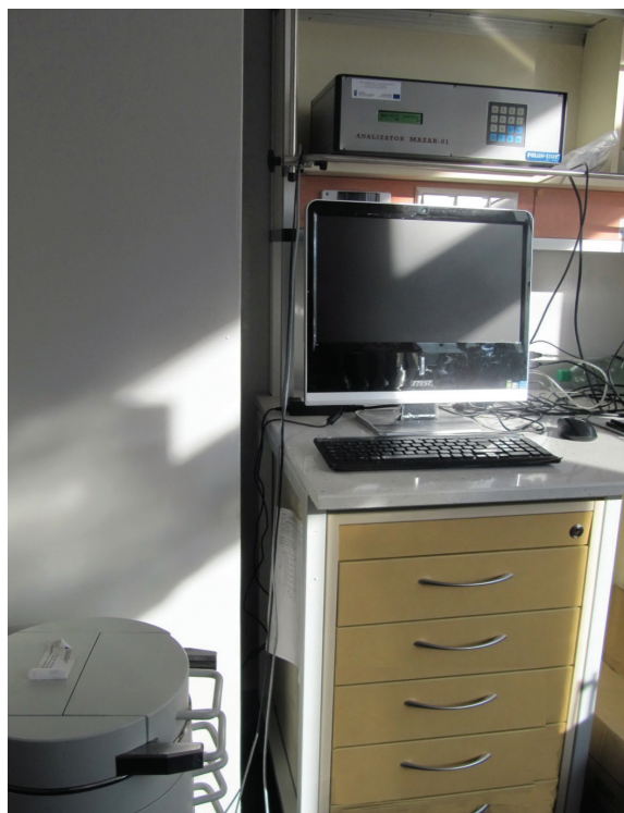
Fot. 7.4. Stanowisko do pomiaru radioaktywności materiałów. Na górnej półce miernik Mazar-0, na dole z lewej osłonny domek pomiarowy
