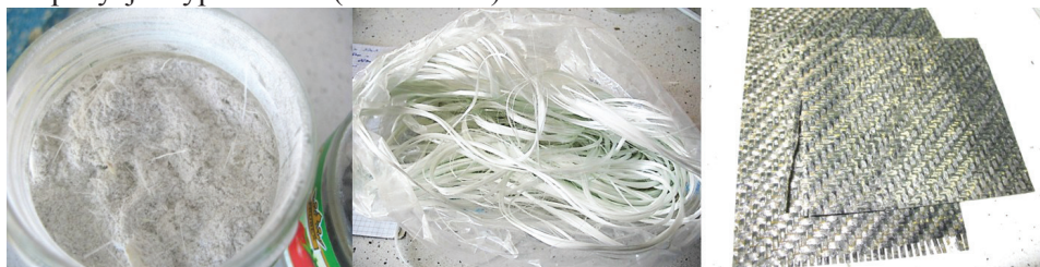
Fot. 6.5. Od lewej: Pył włókna szklanego, włókno szklane w postaci rowingu, spolimeryzowane włókno węglowe
