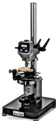
Fot. 5.6. Próbką podczas badania twardości na twardościomierzu Shore'a typ D.
