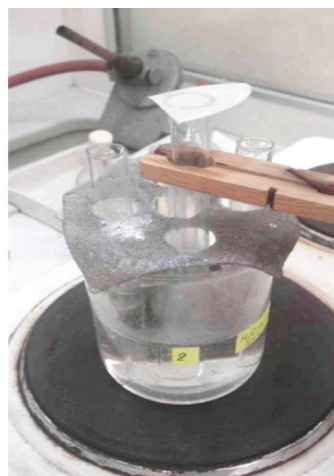
Fot. 5.3. Po lewej: jasnożółty osad po dodaniu \text{AgNO}_3 może świadczyć o obecności fosforanów i chlorków. Po prawej: brak zaciemnienia bibuły oznacza zawartość \text{H}_2\text{S} poniżej 20 \text{ mg/dm}^3
