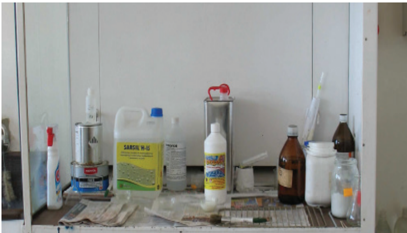
Fot. 4.4. Stanowisko pod dygestorium do nakładania powłok hydrofobowych
