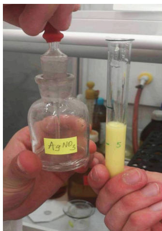
Fot. 5.3. Po lewej: jasnożółty osad po dodaniu \text{AgNO}_3 może świadczyć o obecności fosforanów i chlorków. Po prawej: brak zaciemnienia bibuły oznacza zawartość \text{H}_2\text{S} poniżej 20 \text{ mg/dm}^3
