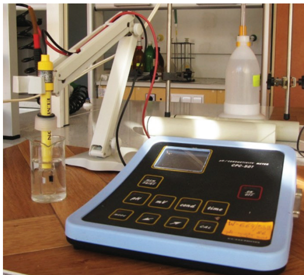
Fot. 5.4. Stanowisko do pomiaru przewodnictwa właściwego wody
