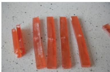
Fot. 6.11 Próbki po badaniu na zginanie. Od lewej z wypełnieniem w postaci rowingu szklanego oraz po prawej - drutu stalowego
